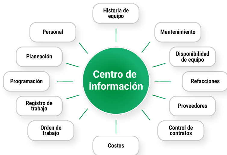
Figura 2. Centro de información del departamento de mantenimiento.
