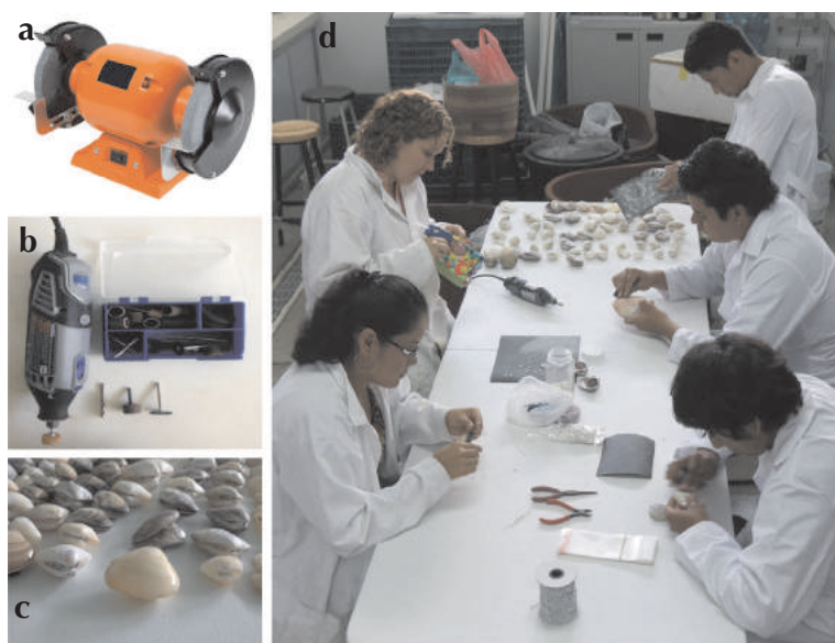
Figura 44. Procesamiento de conchas con a) esmeril y b) dremel para c) remover el periostraco d) Proceso realizado por estudiantes de la UJAT.
