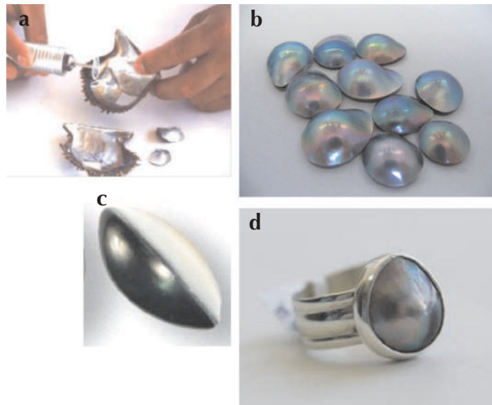
Figura 32. Procesamiento de las mabes formadas en la concha nácar Pteria sterna . a) corte grueso de la concha; b) corte fino y pulido del domo; c) sellado con epóxico y respaldo; d) montaje de la mabe.
