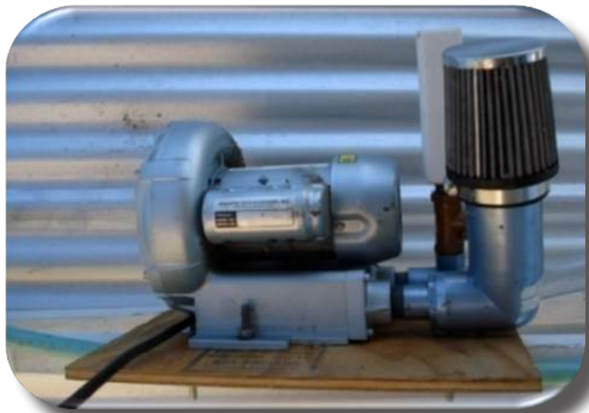
Figura 17. Aireador con capacidad de ½ caballo de potencia (hp) para el suministro de oxígeno.
