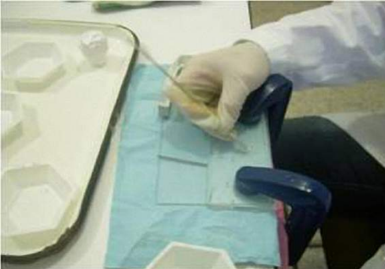
Figura 3. Elaboración de implantes hormonales usando una placa de acrílico para empaquetar la mezcla.
