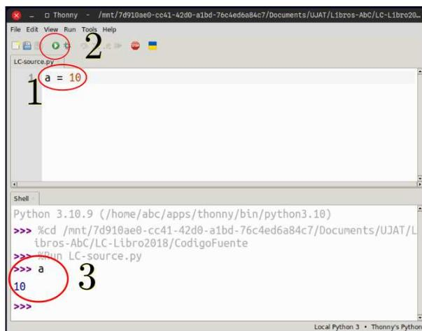
**Figura A.3:** Para usar el IDE de Python, usualmente primero se escribe el código [1] en la sección de definiciones, luego se analiza y ejecuta [2] el código escrito y finalmente se prueba [3] el código desde la sección de interacciones.
