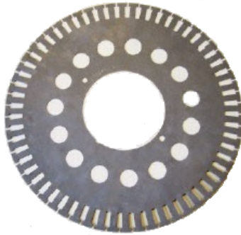
Figura 1.20 Laminaciones de un rotor tipo jaula de ardilla. Fuente: [5]
