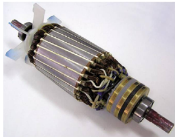
Figura 1.3 Rotor devanado de un motor de inducción. [1]
