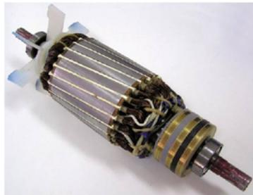
**Figura 1.3** Rotor devanado de un motor de inducción. [1]
