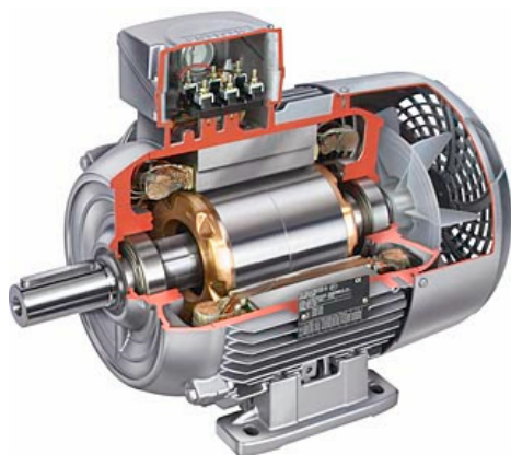
Figura 1.1 Corte de un motor de inducción. [1]
