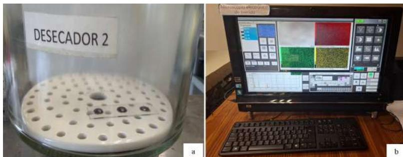
Figura 4. Tratamiento de enmiendas orgánicas: a) desecador, b) equipo SEM-JEOL-JSM-6010-LA.
