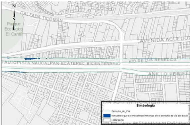
Figura 7.- Predios inmersos en el derecho de vía de los ductos petroleros (10 metros). Elaboración de Valentín Pérez Cruz con información catastral y datos de Ordaz-Ayala (2013)
