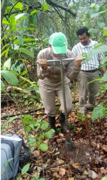
*Figura 4.* Extracción de muestra de suelo con barrena.
