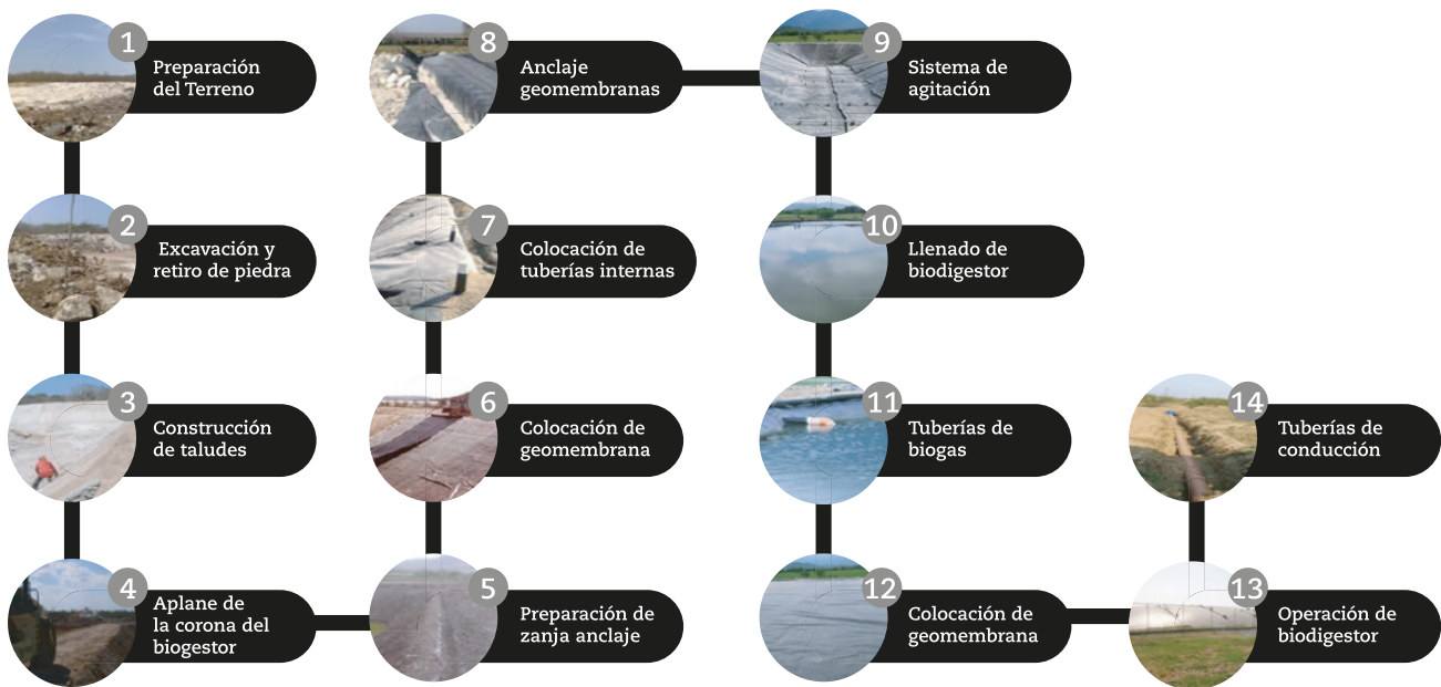
Figura 7. Proceso constructivo de un sistema de biodigestión Fuente: Curso para la formación de capital humano en materia de biodigestión (FIRCO, 2016)
